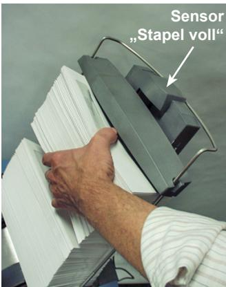
*HINWEIS: Die Poststücke können während des laufenden Betriebs aus dem VPS genommen werden. Der VPS läuft weiter, solange der Sensor „Stapel voll“ nicht länger als 1/2 Sekunde ausgelöst wird.*
