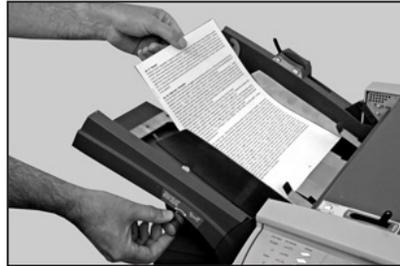
2. Richten Sie die Seitenführungen mit dem Einstellrad bündig an den Kanten der zugeführten Blätter aus, und drehen Sie das Rad dann eine Viertelumdrehung zurück. Dadurch wird der benötigte Abstand zwischen Material und Seitenführungen gewährleistet.
