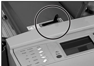
Richten Sie die Seitenführungen mit dem Einstellrad bündig an den Kanten der zugeführten Blätter aus, und drehen Sie das Rad dann eine Viertelumdrehung zurück. Dadurch wird der benötigte Abstand zwischen Material und Seitenführungen gewährleistet.
