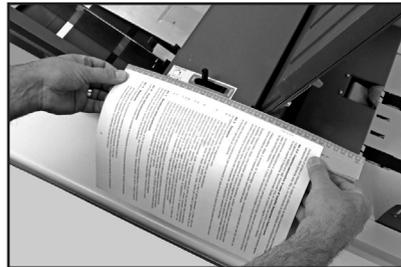
Wählen Sie die entsprechende voreingestellte Länge über die Bedientasten aus (d. h. US Letter / A4), oder wählen Sie „Benutzerdefiniert“, und drücken Sie die Tasten +/-, bis die gewünschte Papierlänge (in Millimetern) angezeigt wird. Wenn die Papierlänge korrekt ist, drücken Sie **OK**.
