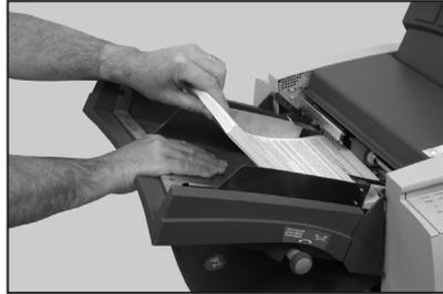
7. Die DF900 kann auch große Blattformate verarbeiten. Die Markierung an der Seitenführung zeigt die korrekte Position des Papieranpassungshebels an.
