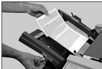
**Hinweis:** Bei Verwendung der manuellen Zuführung darf das Materialgewicht nicht höher sein als 5 Blatt bei 80 g/m<sup>2</sup> bzw. insgesamt 400 g/m<sup>2</sup>. Zur leichteren Bedienung ist die Systemgeschwindigkeit bei Jobs mit manueller Zuführung automatisch auf Stufe 1 eingestellt.
