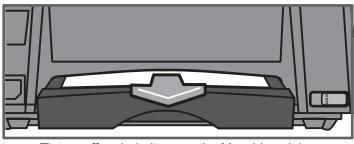
Tintenauffangbehälter aus der Maschine ziehen. Schiebehebel loslassen.
