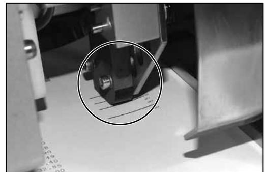
Den Scanner von Seite zu Seite einstellen bis der Scannerstrahl eingestellt ist indem Sie den Scanner manuell betätigen. Den gezeigten Knob lösen, den Scanner einstellen und den Knob wieder festziehen.
