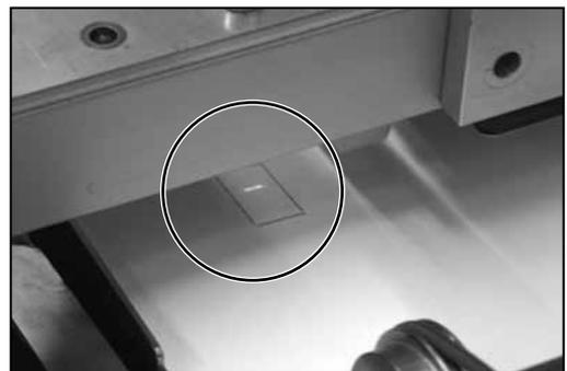
Den Scanner von Seite zu Seite einstellen bis der Scannerstrahl eingestellt ist indem Sie den Scanner manuell betätigen.
