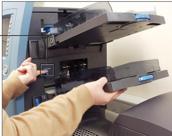
**Abbildung 3.1.1: Anheben der Trennvorrichtung und Einsetzen des Schachts in die Schachthalterungen**
