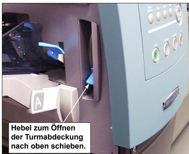
Abbildung 2.2.1: Öffnen der Turm-Zuführung mithilfe des Hebels
