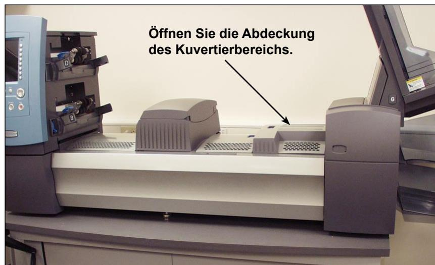
**Abbildung 3.9.1: Abdeckung des Kuvertierbereichs**
