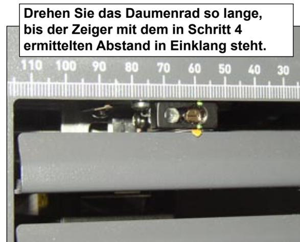
**Abbildung 8.4: Verwenden des Zeigers zum Gewährleisten der richtigen Scankopfposition**
