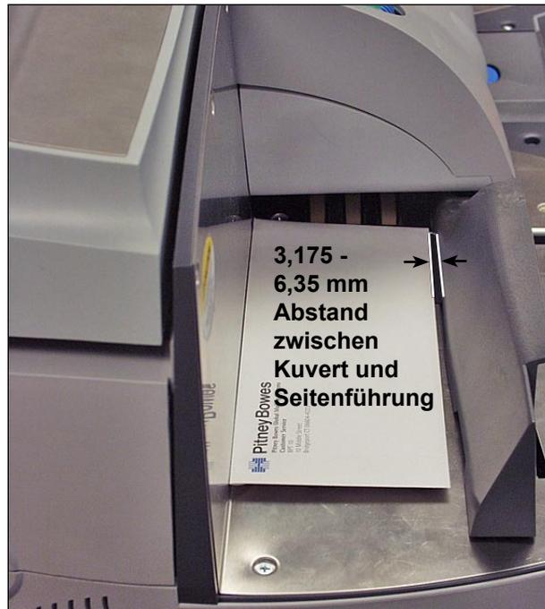
**Abbildung 7.16: Abstand zwischen Kuvert und Seitenführung**
