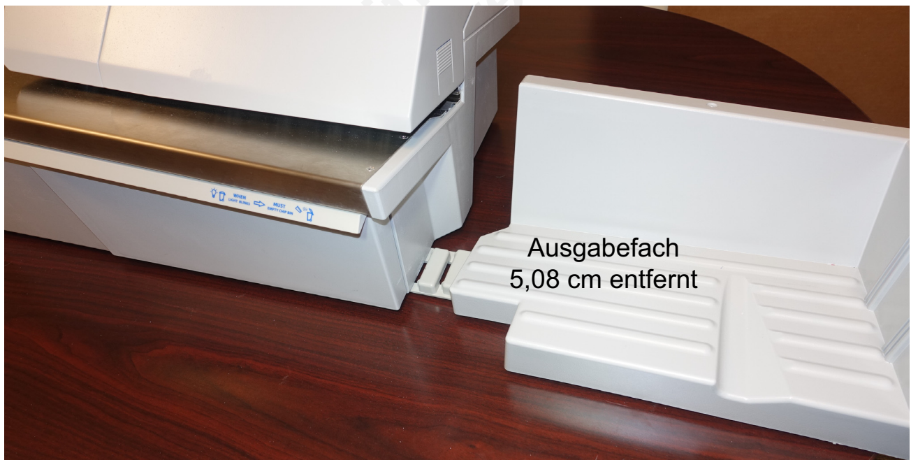
Abbildung 4-12: Ausgabefach 5,08 cm entfernt
