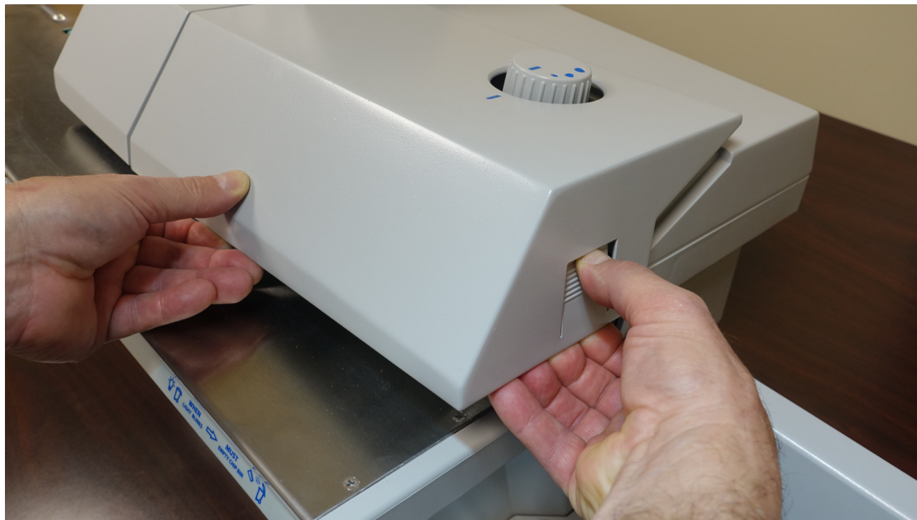
Abbildung 2-7: Auslösung der Verriegelung bei Entfernung der oberen Abdeckung
