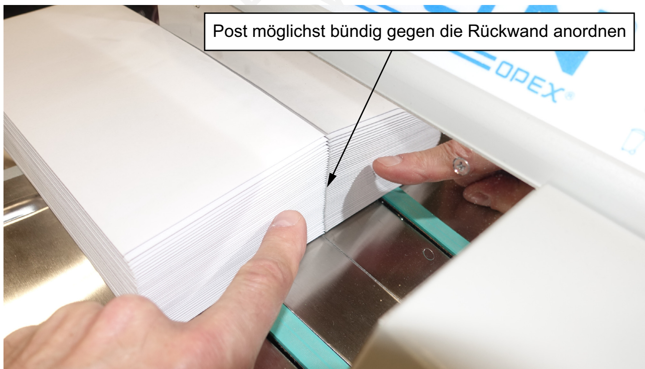
Abbildung 4-7: Post bündig an der Einzugsfachwand
