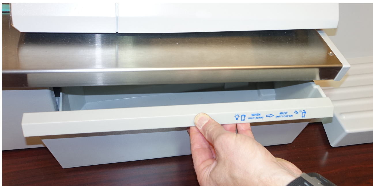
Abbildung 2-8: Auslösung der Verriegelung bei Entfernung des Fachs
