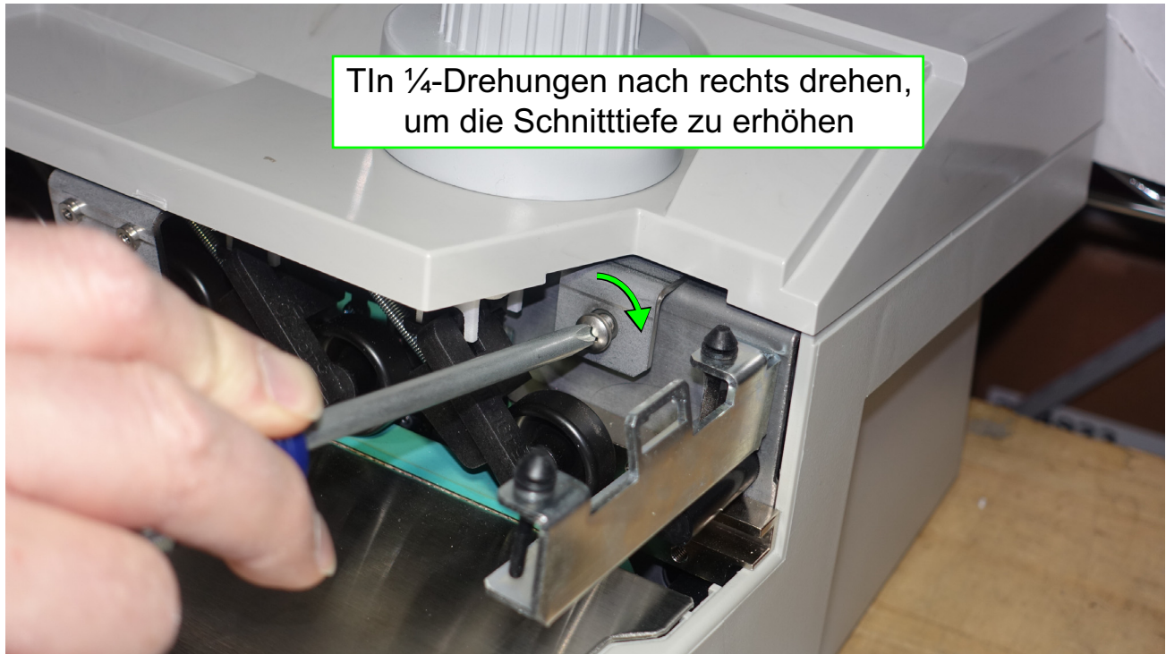
Abbildung 4-18: Tiefenjustierung der Schneidvorrichtung
