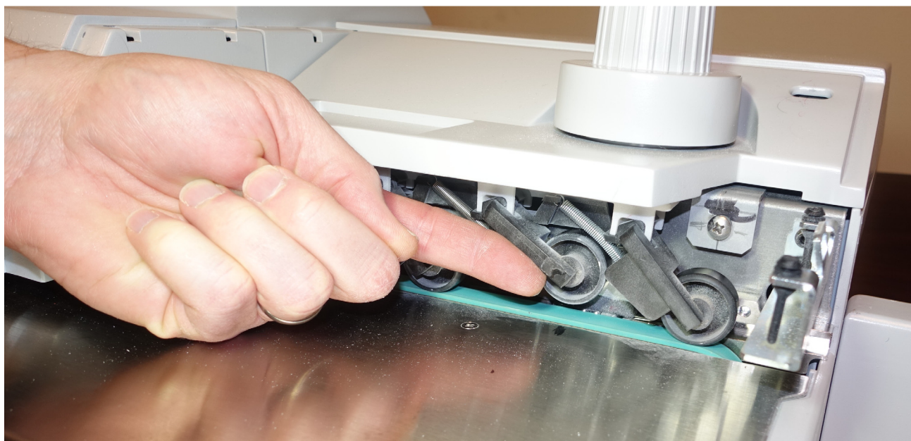
Abbildung 4-16: Reinigung der Walzenrollen
