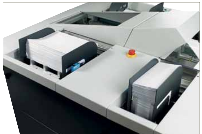
Einzelblattzuführung für 1.000 Blatt und Beilagenstationen für 1.500 Beilagen
