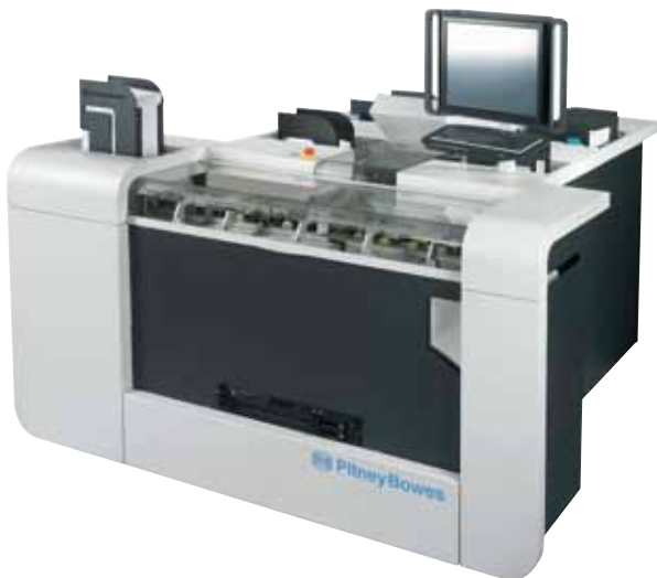
Kuvertiersystem DI6080 mit 6 Beilagenstationen und C4 Option
